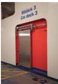
Sliding semi watertight door
